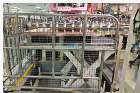
昆山廠區 防護欄安裝鋼絲網
