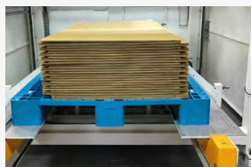
台灣廠區 基板分離機構與自動輸送系統
