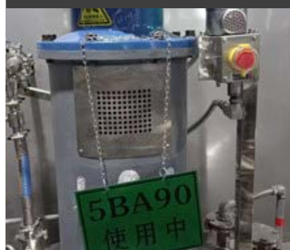
新增調膠槽通電指示燈及緊急停止開關
